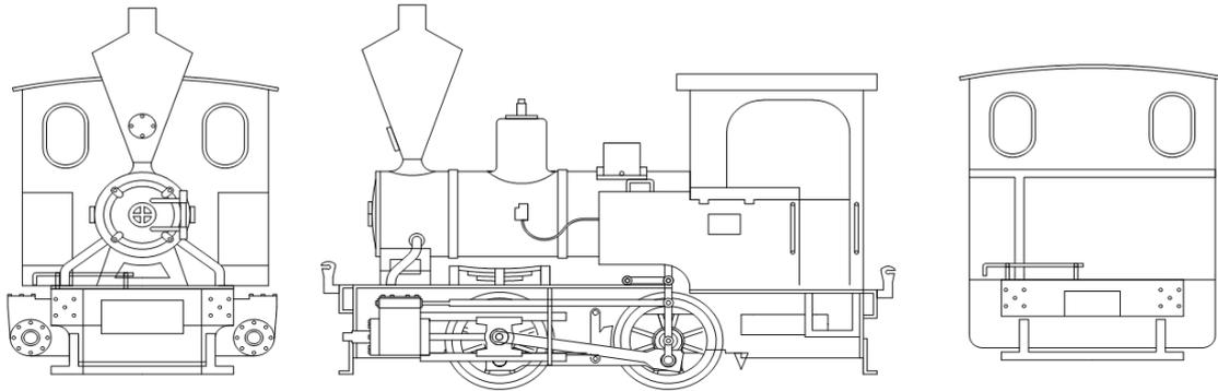
今回のコッペルBタンクは16番の機関車では コッペル弁装置を組み込んだ製品は過去には存在せず本邦初の試みになります。キット内容は 車体はエッチングとロストワックスを使用し メインフレームはt0.6のワイヤー放電切抜になります。製品は カプラーのみ別売りです。カプラーはIMON製HO101がお勧めです。
