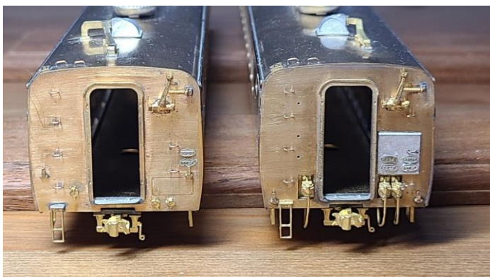
後位妻ジャンパー栓取付例 (右: 130mm欠取あり)
