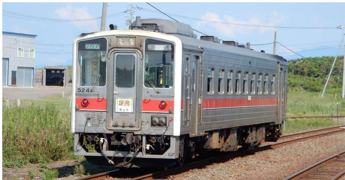
北海道地区の老朽化した一般型気動車の置き換え用として、酷寒冷地仕様のキハ54形500番台が1986年から製造されました。501～526号車は一般仕様、527～529号車は急行仕様で、合計29両が国鉄時代の晩年に新製されました。駆動機関は地域性を考慮し、降雪時における1両での運転を目的として、2基のエンジンを搭載した強力形となっています。これにより、在来車と比べて加速性能が大幅に向上しました。また、将来のワンマン運転に備えて、ワンマン運転用の機器が取り付け可能な構造となっています。
