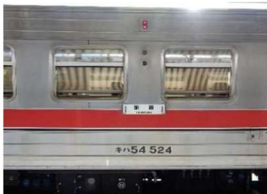
←窓の傾斜はプレス加工で傾斜した窓の淵部品を製作し、車体と異なるステンレス色に塗装して、車体の窓の開口部にはめ込んで表現します。
