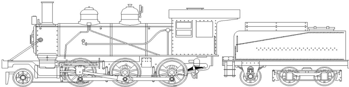
今回模型化する際に特に拘ったのはメインフレームになります。現在のプラス製鉄道模型ではエッチング板によるフレーム構造ですが 今回の8100は昔ながらの造りを目指して ワイヤ放電切り抜きによるt1の厚みを持たせて仕上げます。また デイティールはロストワックスをメインに製作します。発売は2020 9月以降の予定になります。
