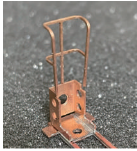
3.B-10をB-9の穴2箇所に通し込みハンダします。
