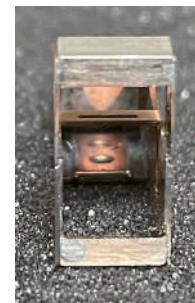
4. C-22をB-13後部に差し込みハンダを流して固定します。またB-29をB-13後部に当てはめハンダします。
