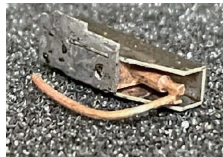
10.O.L-4Rを中に差し込みます。突起が引っ掛かる場合は多少削ります。
