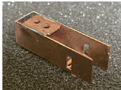
12. B-14をB-13裏側の窪みに当てはめハンダを流します。重ねた部分は背面になるようにします。
