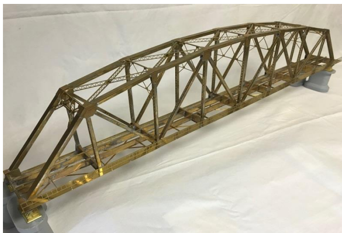
曲弦ワーレントラス試作品 支間 : 816mm
