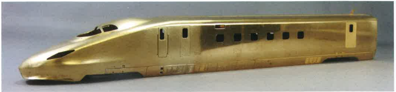
写真は製作途中の車体です。
