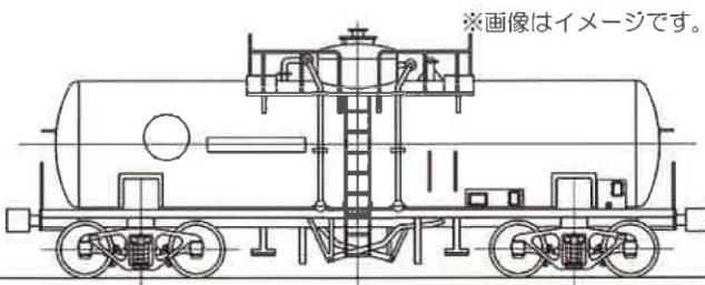
タキ10700形タンク車は希硝酸専用車として初の35t積車で、昭和43年から60両が製作されました。
