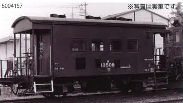
■ヨ5000形は1959年から1,000両以上が製造された国鉄を代表する車掌車です。当初から二段リンク台車を採用、最高許容速度85km/hでの運用が可能でした。改造による編入やバリエーションも多い形式ですが、今回リリースするのはヨ3500形の二段リンク改造車(13500～)で側窓が小さく、中央寄りで少し高い位置にある初期型のうち、デッキの腰部が鋼棒組立て構造となっており、クラシカルな外観が特徴です。
